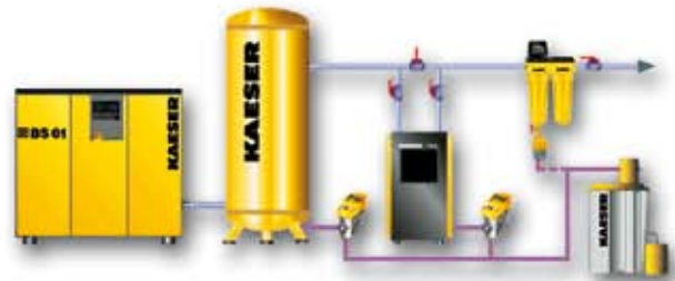
Druckluft-Aufbereitung (Filter, Kondensat-Aufbereitung, Adsorptionstrockner, Aktivkohleabsorber)
