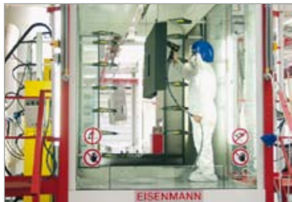
In der Pulverbeschichtung erhalten die Maschinen ihre dauerhafte Lackierung
