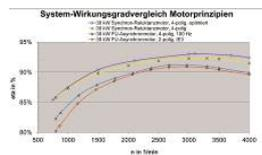
Im Vergleich zeigt der Synchronreluktanz-Motor deutlich bessere Wirkungsgradwerte.
